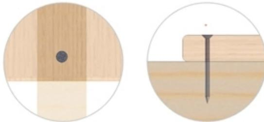
**2** Устанавливаем крепеж вертикально вплотную к доске и легким ударом молотка по головке крепежа намечаем место входа крепежа в основание. Не вынимая острие якоря крепежа из основания, левой рукой наклоняем его до угла 45-60° и начинаем забивать молотком, придерживая рукой.
