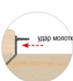
**4** Устанавливаем гвоздь в отверстие крепежа и забиваем его в доску.
