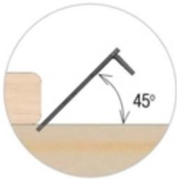
**3** Ударом молотка забиваем якорь крепежа в основание, затем ударом молотка приводим головку крепежа в вертикальное положение.
