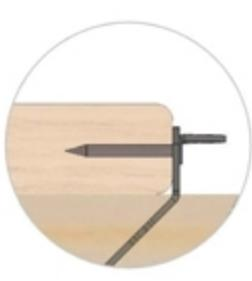
**5** Устанавливаем вторую доску на основание, устанавливаем сборку А-спейсеров, встаем на доски как показано на рисунке, ударами молотка через прокладку набиваем вторую доску на шипы крепежа.
