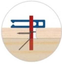
**6** Повторяем действия 2-5, удаляем А-спейсеры только после монтажа всей конструкции террасы, свободный край последней доски фиксируем шурупами.
